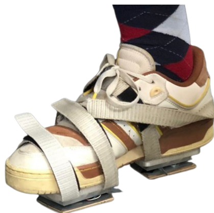
FIGURE 18 – Prototype de l'intégration du module de charge
